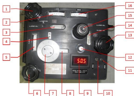
Figura 2. Gravímetro y sus componentes
